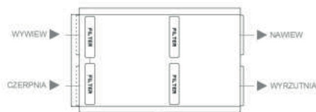
Centrala serii VW - wersja wykonania: prawa (widok od strony inspekcyjnej)
