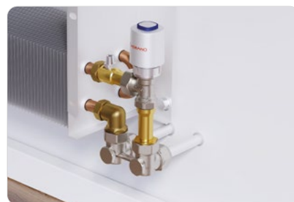
Przykładowy montaż głowicy bezprzewodowej lub siłownika wewnątrz obudowy grzejnika (grzejnik typu V, wykonanie specjalne)
